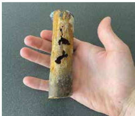
Tuyau qui servait à la distribution d'eau, découvert lors de la phase actuelle du chantier.
